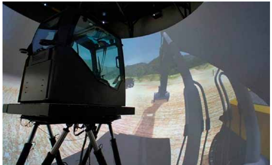
Obr. 1 „human-in-the-loop“ simulátor pro testování nových stavebních strojů
