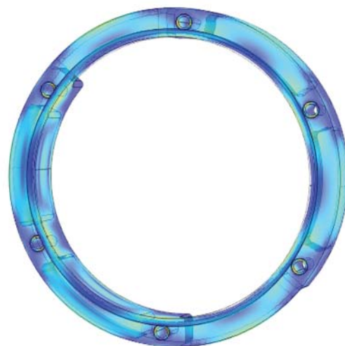
Obr. 2: Výsledné namáhání odstředivými silami. K největšímu namáhání součástky dochází v oblasti uchycení.
